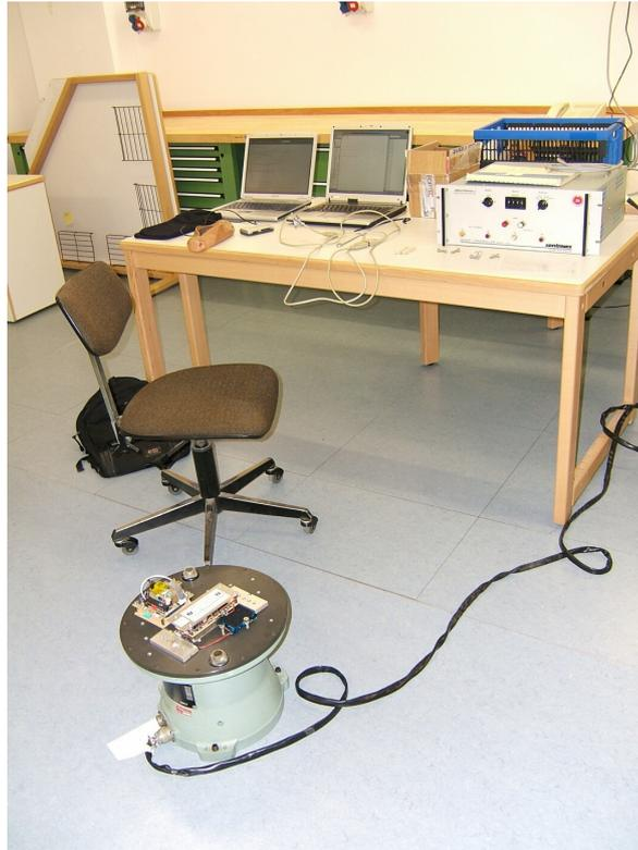
Abbildung 7.6: Versuchsaufbau mit Drehtisch am ISD. Im Vordergrund ist der Drehtisch, rechts auf dem Tisch das Steuergerät zum Drehtisch, links daneben die Computer für die Auswertung und den Datenlogger zu sehen.
