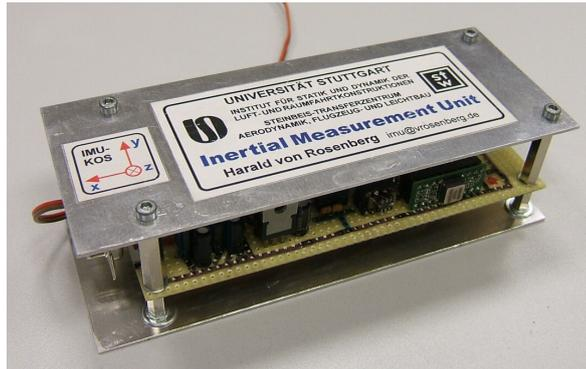
Abbildung 4.3: IMU-Prototyp montiert im Rahmen aus parallelen Aluminiumplatten
