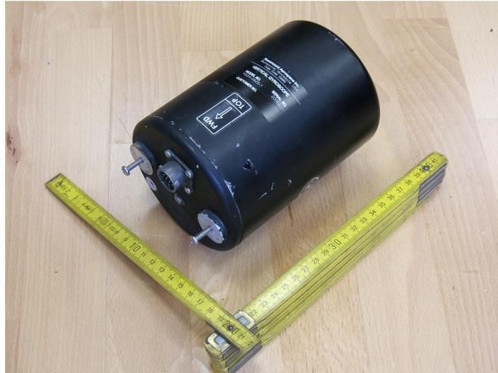
Abbildung 2.1: Vertical Gyroscope von **ROSEMOUNT AEROSPACE INC.**
